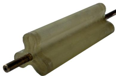
Рис. 2. Конструкция роторно-лопастного рабочего органа с тремя лопастями
