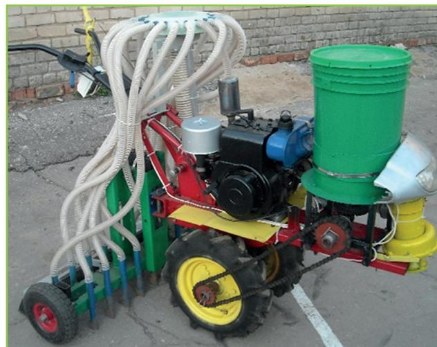
Мини-селялка выполнена на базе мотоблока МБ-1, оборудованного генератором постоянного тока с напряжением 14,4 В для подключения электрического вентилятора пневмосистемы селялки.
